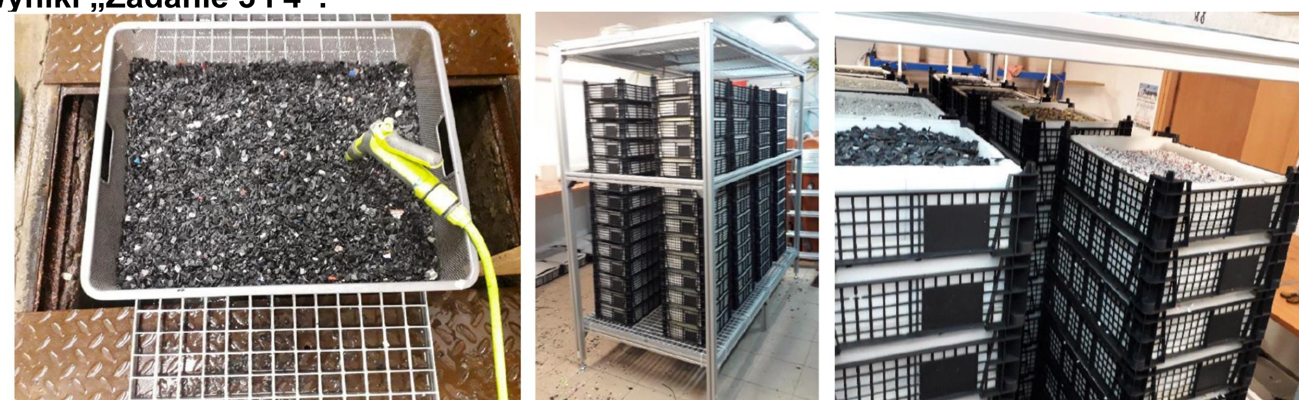
Rys. 3. Przygotowanie materiału ABS przed napełnieniem skrzynek filtracyjnych złoża biologicznego w skali technicznej
