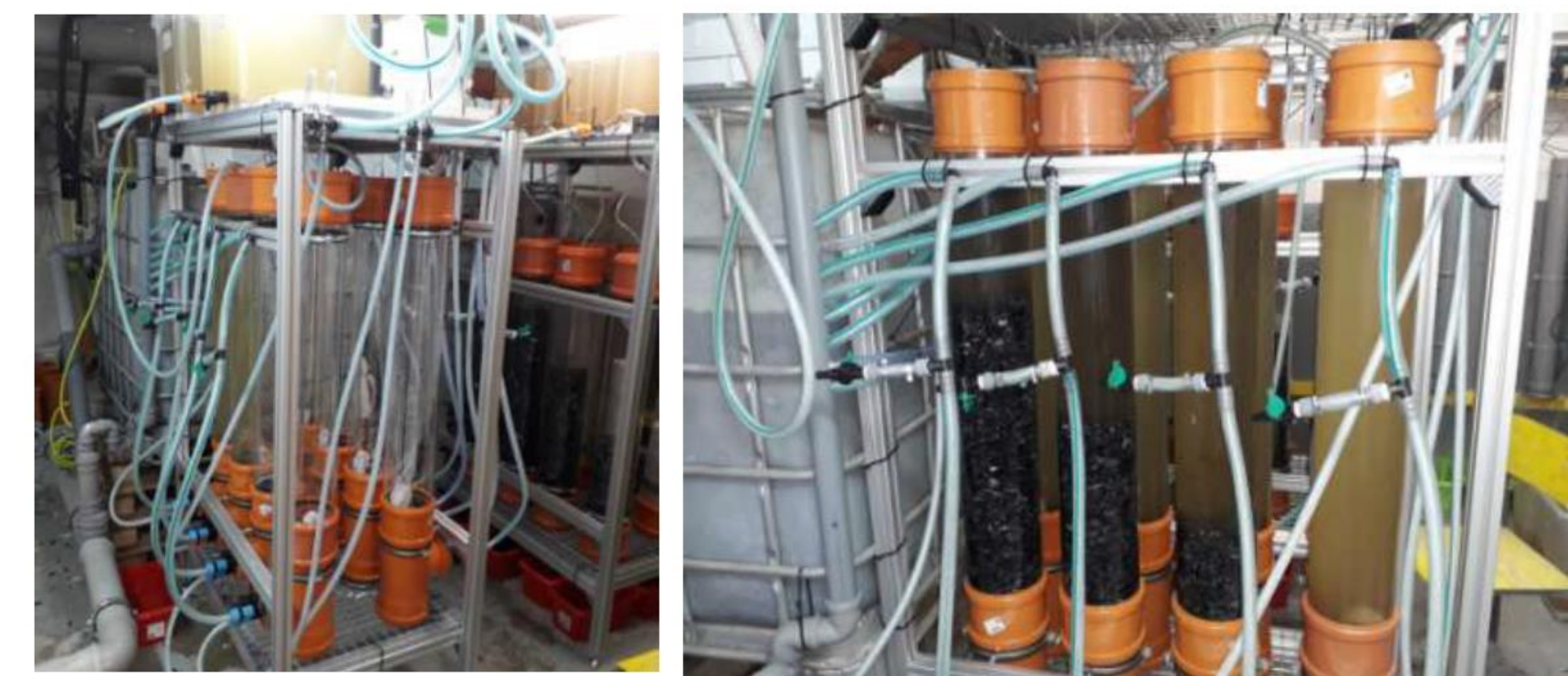
Rys. 2. Stanowisko badawcze – reaktory biologiczne, skala laboratoryjna
