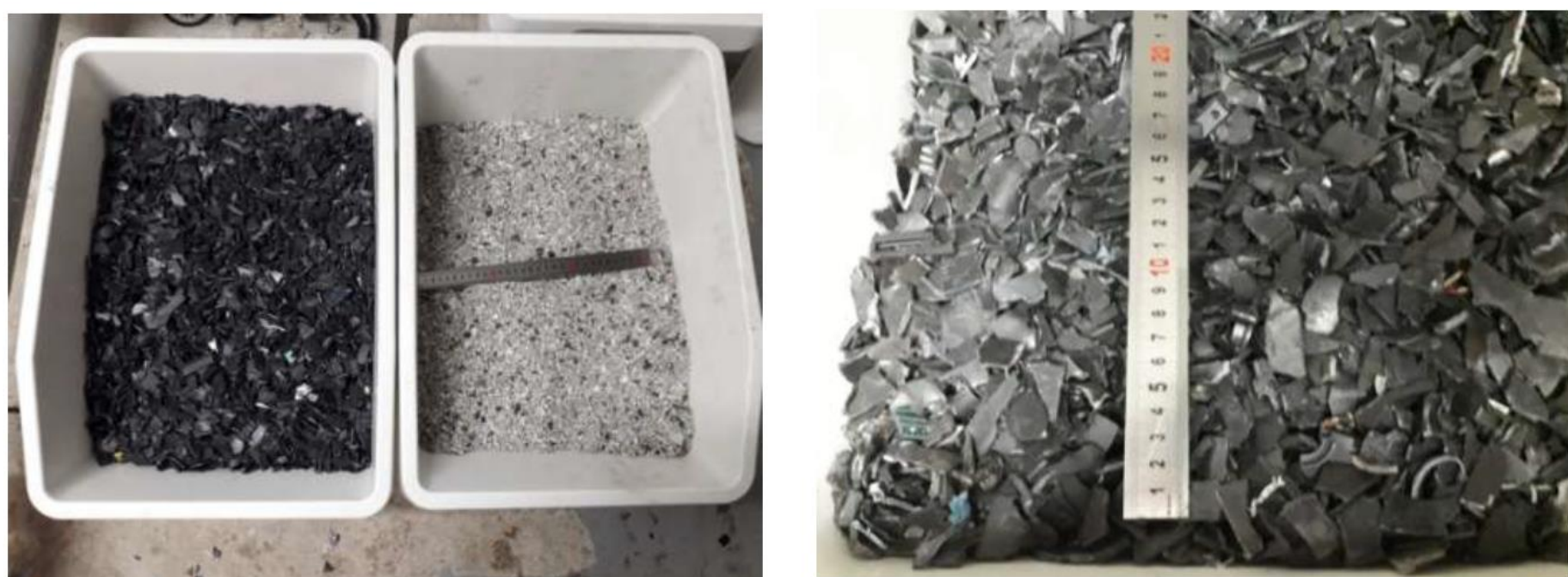
Rys. 1. Materiał ABS z recyklingu zastosowany jako wypełnienie złoża biologicznego
